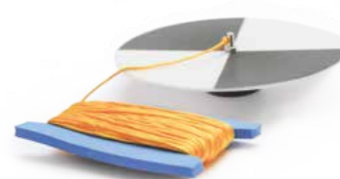
Secchiho deska pro měření průhlednosti vody v rybnících
