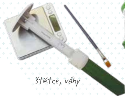
datalogger „lízátko“ pro měření teploty vzduchu i půdy a půdní vlhkosti
